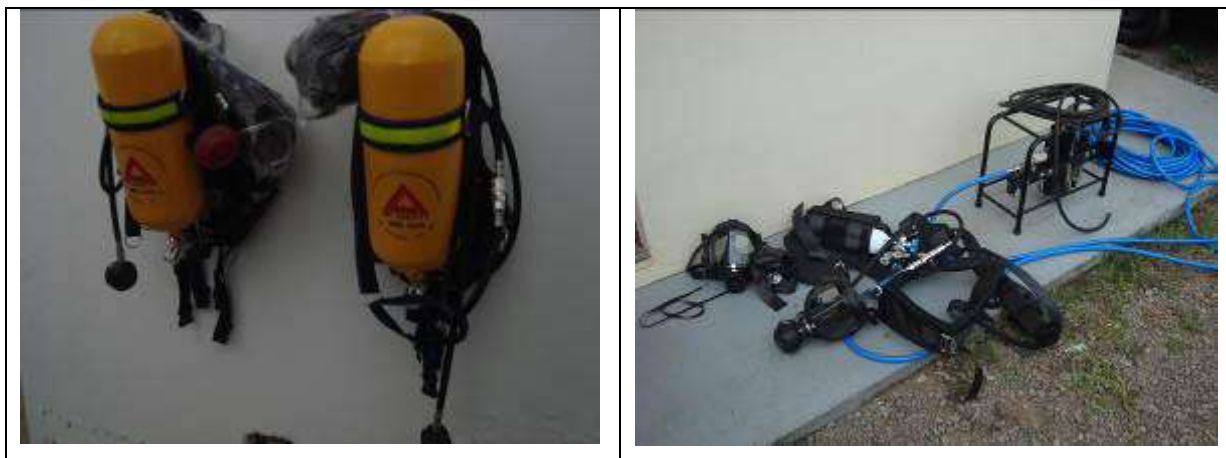
Figuras 17 e 18 – Equipamentos para entrada em espaços confinados com atmosfera Imediatamente Perigosa à Vida e à Saúde – IPVS – adquiridos pelas empresas notificadas
