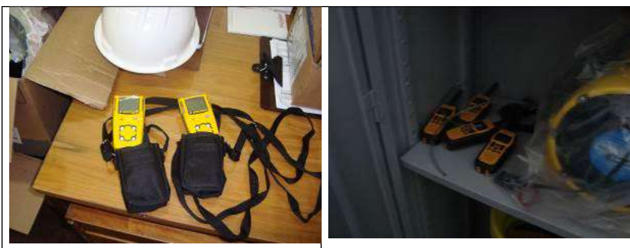
Figuras 15 e 16 – Equipamentos para avaliação da atmosfera de risco dos espaços confinados e de comunicação entre os trabalhadores adquiridos pelas empresas notificadas
