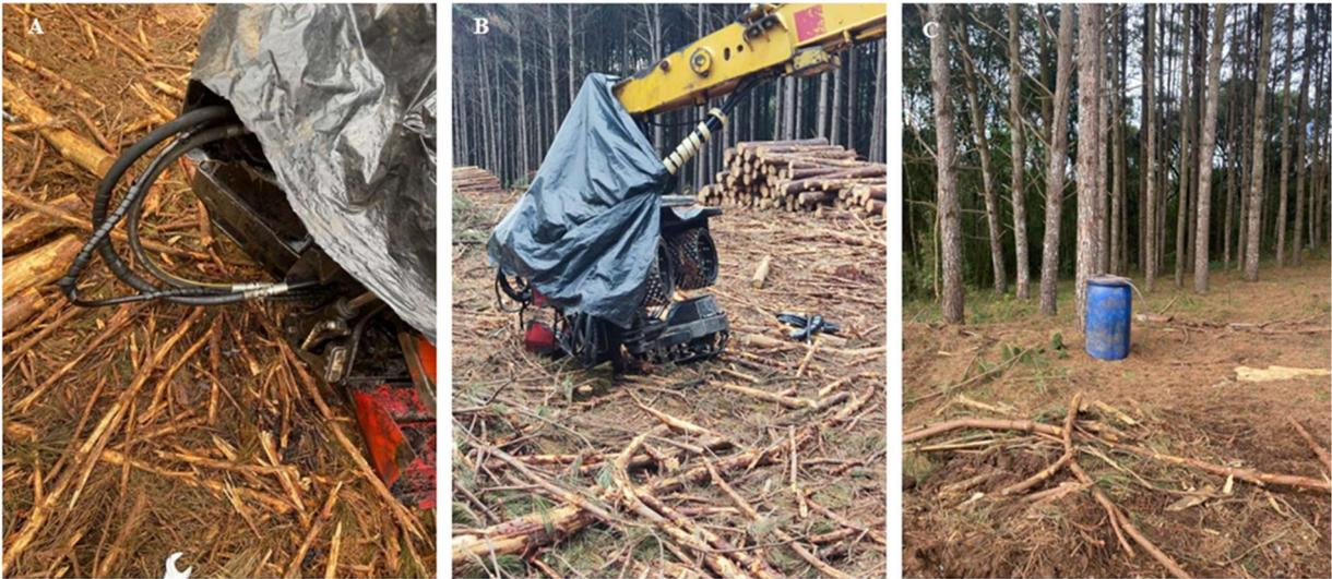
Legenda: Figura A e B: Contaminação do solo durante a manutenção das máquinas; Figura C: Tambor de 200 L contendo combustível depositado diretamente no solo
