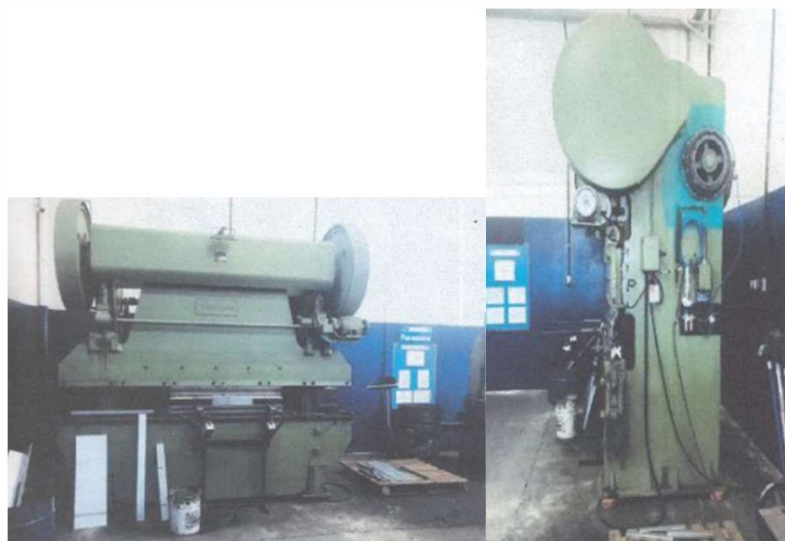
Figura 1 - Prensa dobradeira com acionamento por freio/embreagem (fricção) mecânica tipo cinta.
