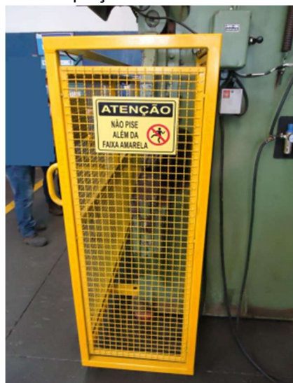
Figura 8 - Adequação de barreira na área lateral.
