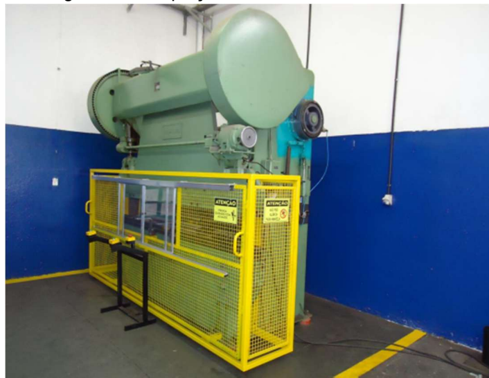
Figura 7 - Adequação de barreira na área frontal.
