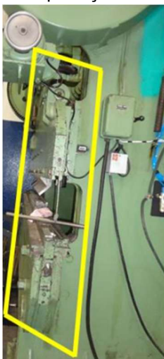
Figura 5 - Ausência de proteção na zona de prensagem
