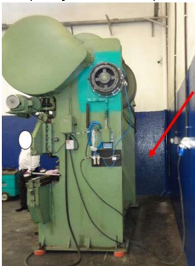
Figura 6 - Ausência de proteção coletiva no perímetro da máquina dobradeira.
