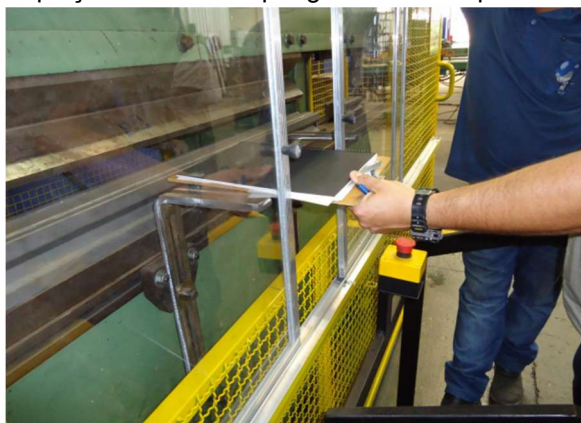
Figura 10 - Adequação da zona de perigo e botão de parada de emergência.
