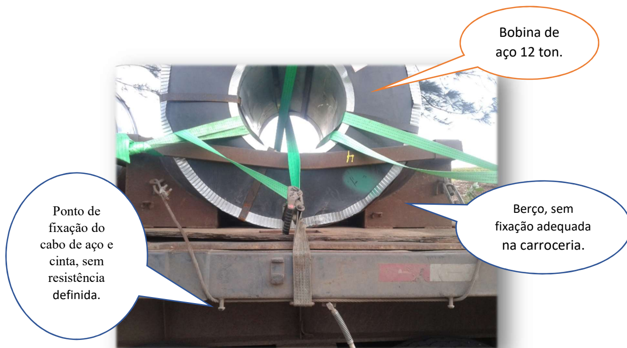
Fig.06. Vista da bobina de aço de 12 toneladas sobre berço enferrujado e fixado por cabo de aço em pontos destinados à fixação de lonas, sem resistência definida, bem como uso de cintas de resistência ignorada.
