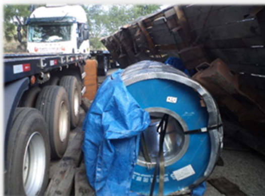
Fig.04. Uma das bobinas de aço de 10 toneladas que caiu da carreta em uma curva na saída do Porto do Pecém.
