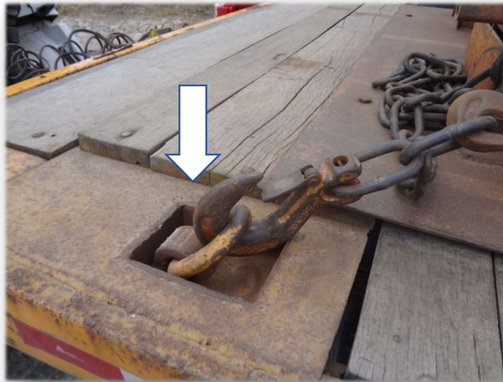
Fig. 08. Exemplo de ponto de fixação (amarração) de bobinas de aço em carroceria de carretas.
