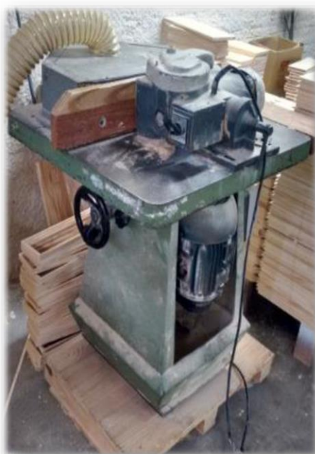
Figura 1 - Máquina Tupia antes da realização de análise de riscos e implementação de melhoria
