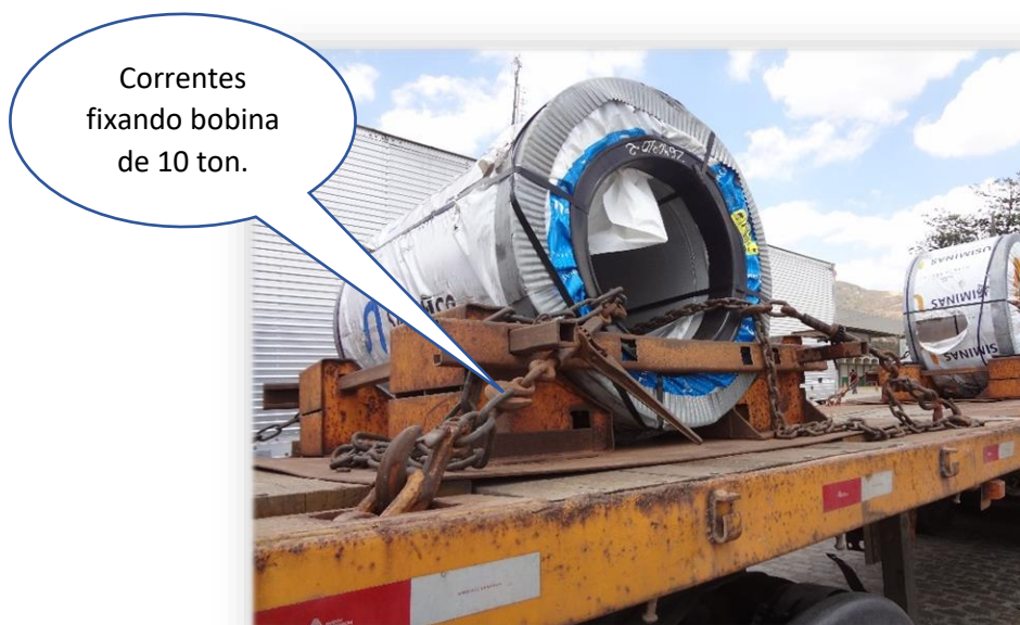
Fig. 08. Exemplo de ponto de fixação (amarração) de bobinas de aço em carroceria de carretas.
