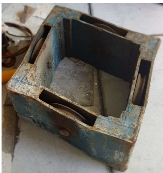
Figura 6 - Corpo telescópico da grua envolvida no acidente.
